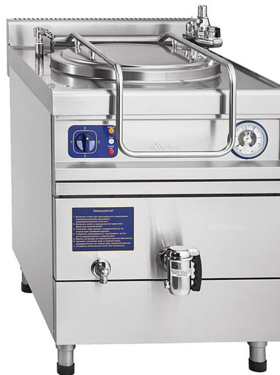
Варочный котел **\*\*Abat КПЭМ-60/9-Т\*\*** предназначен для приготовления вторых и третьих блюд, бульонов, соусов и десертов, а также для кипячения воды на предприятиях пищевой промышленности и общественного питания. Модель оснащена механической панелью управления и сливным краном, позволяющим производить слив готового продукта и регулируемые по высоте ножками.
